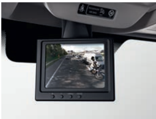
3 VISIÓN TRASERA PERMANENTE* con una cámara en la parte trasera del techo para visualizar lo que sucede tras el vehículo.
