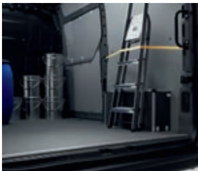
Paredes laterales y suelo de polipropileno antideslizante de 6 mm
